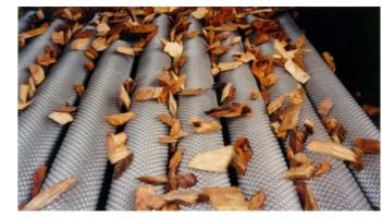
轴厚度筛选机上的每一片木片都有序的顺着其边沿通过控制狭缝从而得到筛选,而不同于其它筛选机,将木片抛向空中,然后凭着木片边沿先着陆而掉入孔隙的机率来进行筛选。钻石型辊轴筛选机并且能保证长久的高筛选效率,因为其无摇动和无振动的特点,使得筛选机保持着孔隙的精度。钻石型辊轴筛选机的轴间筛孔(IRO)精度是其它厚度筛选机的四倍以上。
