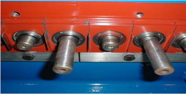
轴距的调整是通过轴承座间的垫片来实现的。安装在机器侧面结构中的轴承座是通过垫片间隔开来的。如果需大的筛孔，可增加垫片。反之，可使用较薄的垫片。无论何种情形，调整筛选机是非常简捷的事，可以在短短几小时内完成，而毋需特殊的工具。
