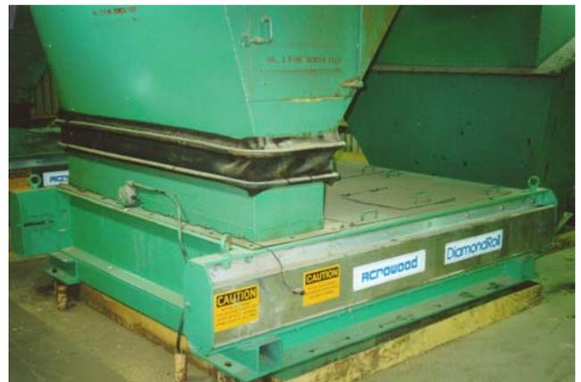
钻石型辊轴筛选机配备了转速传感器。但它不需要配置监测振动或过度运动的传感器。
