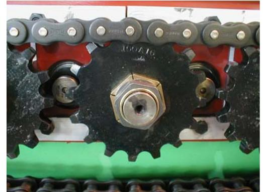
这种单环连续的链传动使得可变筛孔(VIRO)的特性成为可能，因为辊轴可安放于任何位置不受链节限制。事实上，任何筛孔大小组合都可由此实现，从而可满足任何可想象的筛选目标。
